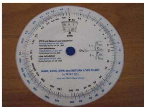
Lo strumento è un regolo progettato da [Patrick TKSEP](#) e da lui disegnato con il software Galva. Consente di calcolare rapidamente e con sufficiente precisione diverse grandezze utilizzate quando si lavora con i circuiti a RF o con le antenne.
